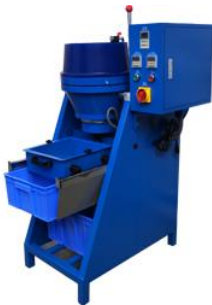
Галтовочная машина MPZ 20 (производитель TONZZE, Китай)
